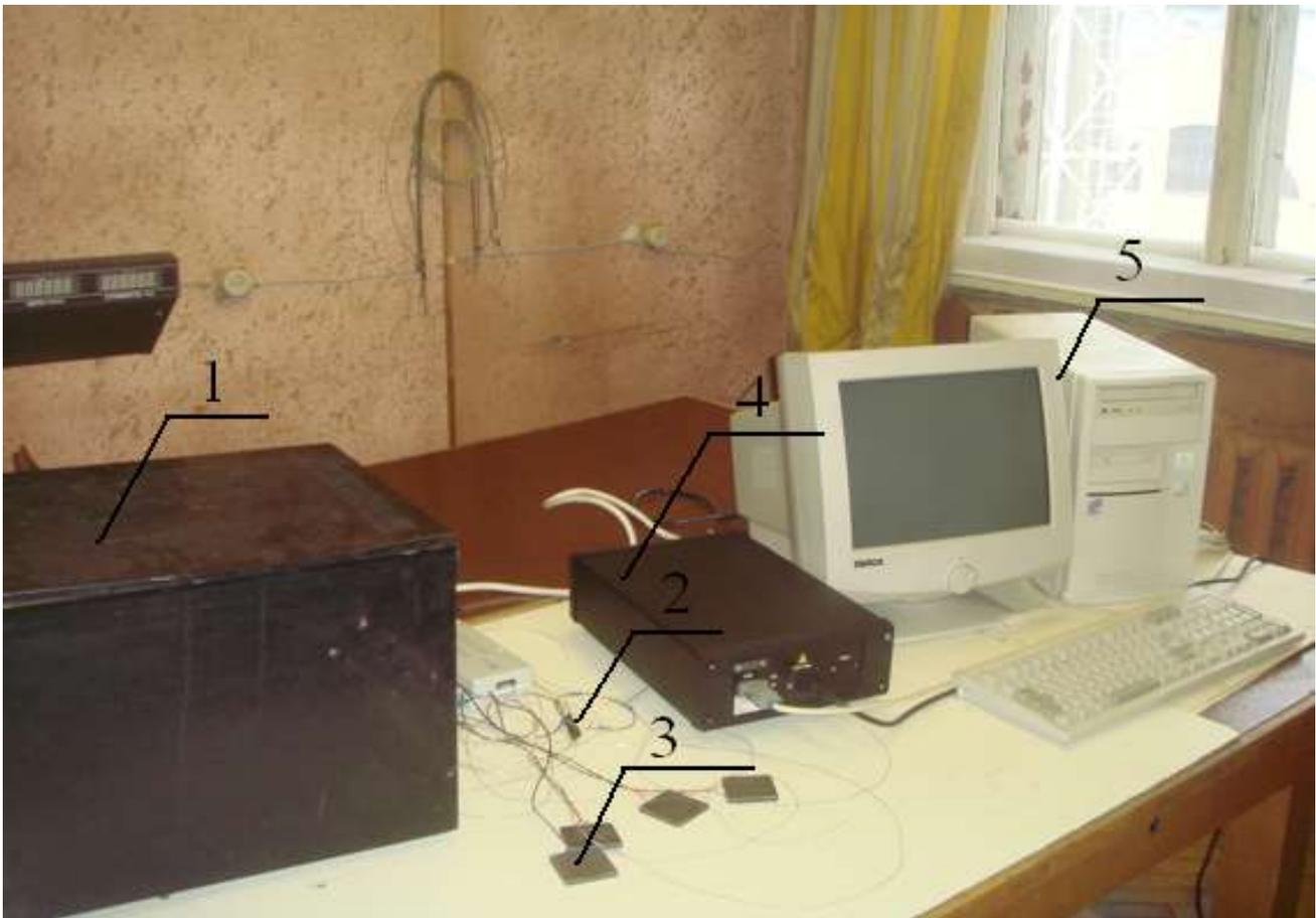
Рис. 1. Экспериментальный стенд для исследования процессов тепловой обработки пищевых продуктов при ИК-энергоподводе: 1 – сушильная камера, 2 – термопары, 3 - датчики плотности теплового потока, 4 – измеритель теплопроводности многоканальный ИТ-2, 5 – персональный компьютер
