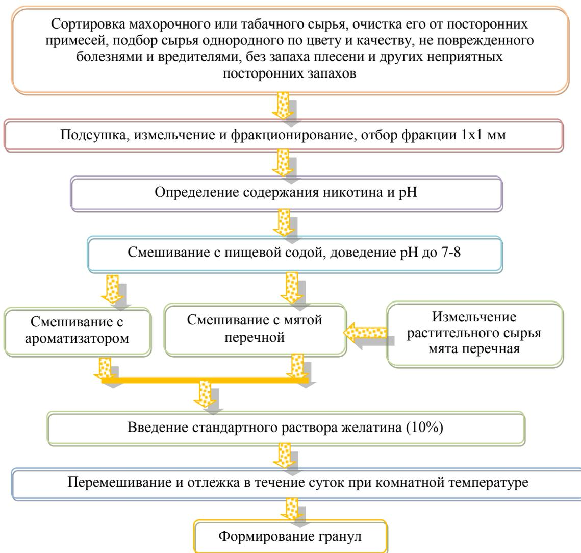
**Рисунок 2.** Усовершенствованная технология изготовления жевательного табака
