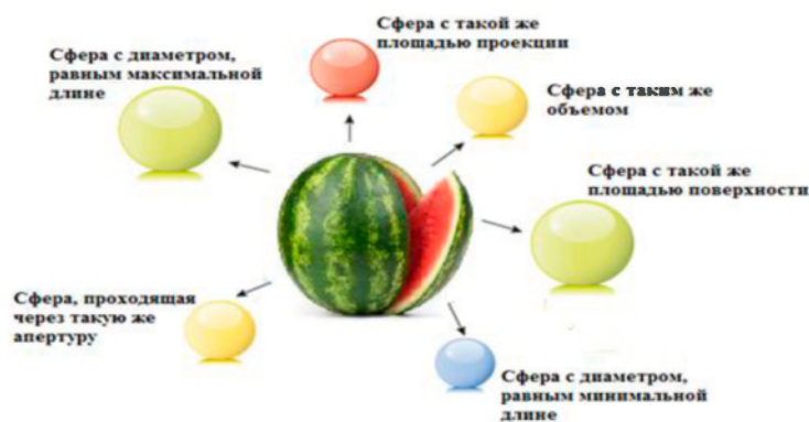
Рис. 2. Пути преобразования реальных размеров частицы в эквивалентный сферический диаметр
